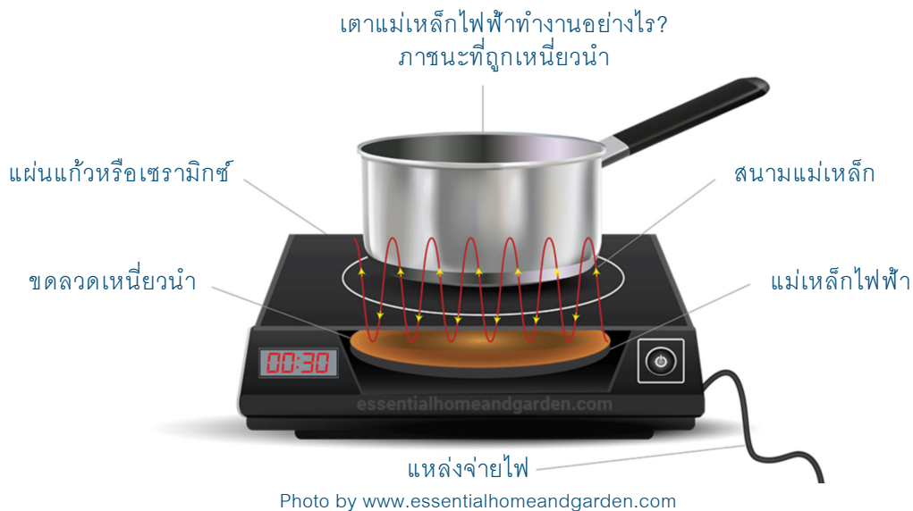
ภาพที่ 11 หลักการทำงานของเตาแม่เหล็กไฟฟ้าเหนี่ยวนำโดยใช้กระแสไฟฟ้าเหนี่ยวนำให้เกิดสนามแม่เหล็กและกระแสไหลวน ซึ่งไหลผ่านกั้นภาชนะและทำให้เกิดความร้อนขึ้น
