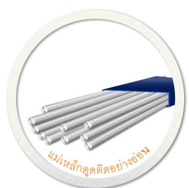
ภาพที่ 12 ตัวอย่างผลิตภัณฑ์สแตนเลสออสเทนิติกที่ผ่านการขึ้นรูปเป็นซึ่งทำให้มีแรงดูดติดกับแม่เหล็กในบริเวณที่ผ่านการขึ้นรูปเย็นด้วยแรงอัด โดยไม่ผ่านกระบวนการทางความร้อนเพื่อปรับปรุงโครงสร้าง เช่น ขอบของม้วนคอยล์ที่ถูกตัดขอบ (ซ้าย) ผนังของหม้อซึ่งถูกแรงอัดจากการแปรรูปเย็นในสัดส่วนที่แตกต่างกัน (กลาง) และลวดเชื่อมสแตนเลสที่ถูกดึง (ขวา) ให้มีขนาดตามต้องการ (ขวา)
