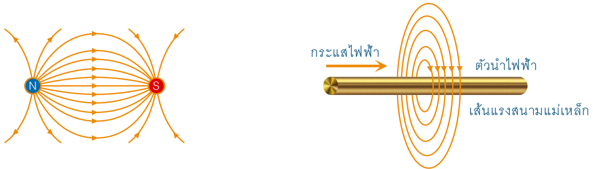
ภาพที่ 10 เส้นแรงแม่เหล็ก เป็นเส้นที่แสดงทิศของสนามแม่เหล็ก มีทิศทางจากขั้วเหนือไปยังขั้วใต้ (ภาพซ้าย) เส้นแรงแม่เหล็กที่เกิดรอบขดลวดตัวนำที่มีกระแสไฟฟ้าวิ่งผ่าน (ขวา)
